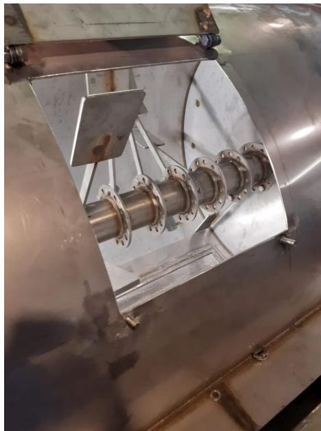
Rysunek 4. Suszarka biomasy obrotowa typu „rolling-bed” zaprojektowana podczas realizacji projektu BIOCARBON - Lider IX.
