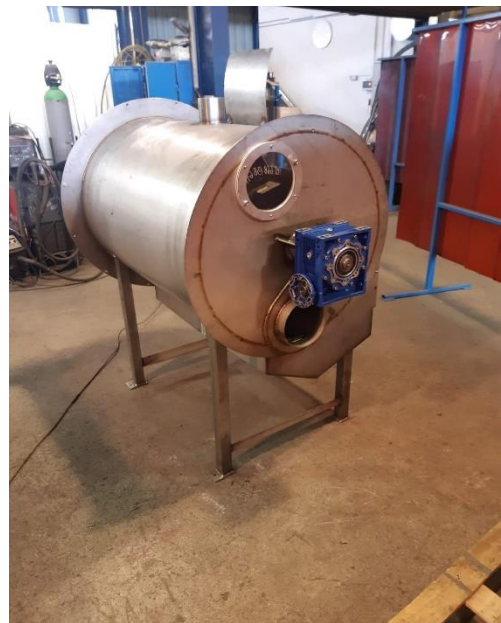
Rysunek 4. Suszarka biomasy obrotowa typu „rolling-bed” zaprojektowana podczas realizacji projektu BIOCARBON - Lider IX.
